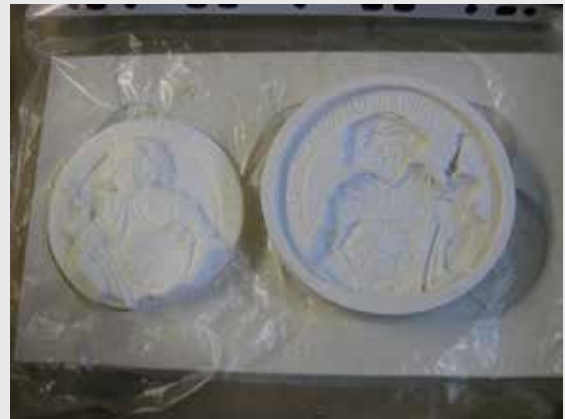
Abb. 6: Gussform mit Werkstück/Reliefs
