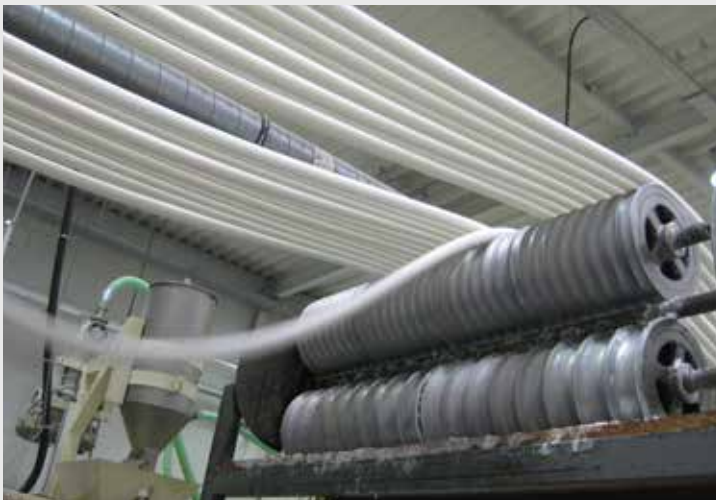
Abb. 8: Kerzenzug auf der Zugmaschine
