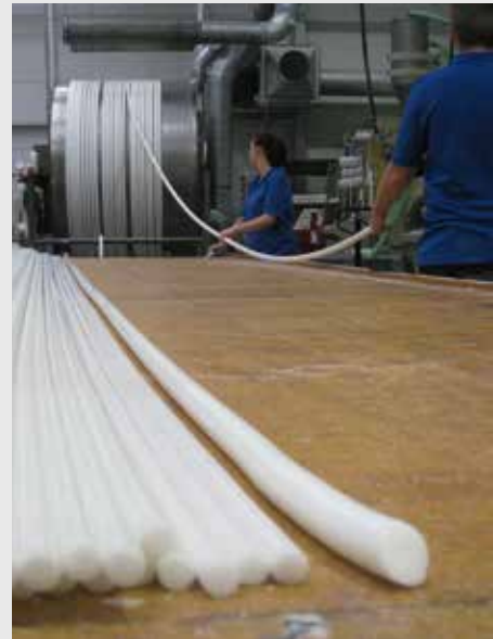
Abb. 5: Abnahme des Kerzenzuges
