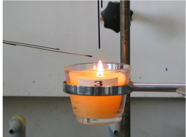
Abb. 10: Brennende Bienenwachskerze mit Thermoelementen während der Messung
