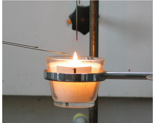
Abb. 4: Brennende Stearinkerze mit Thermoelementen während der Messung
