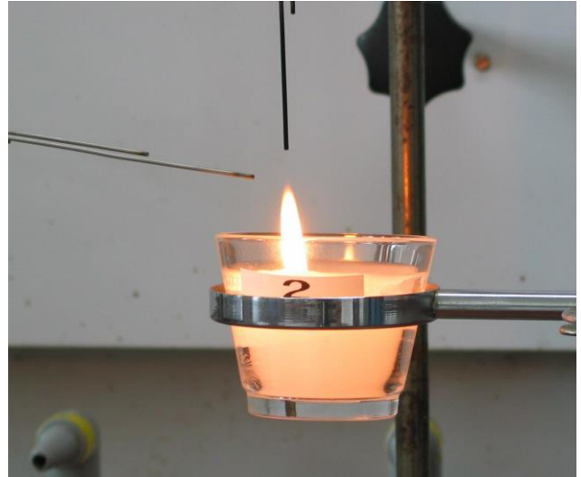
Abb. 7: Brennende Paraffinkerze mit Thermoelementen während der Messung
