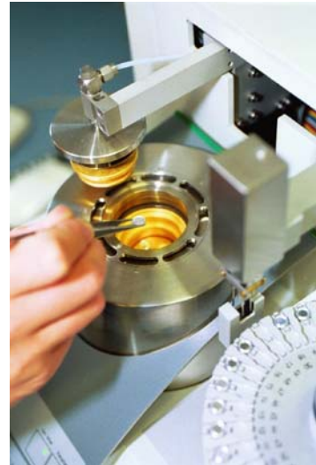
Bild 19: Gerät für Schmelz- und Erstarrungsuntersuchung (DSC)
