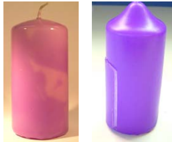
Bild 27: Luft unter dem Tauchmassenmantel
