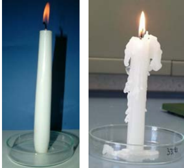
Bild 16: Schmelzpunkt und Brennverhalten von Kerzen
