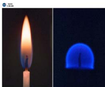
Bild 32: Kerzenflamme mit und ohne Gravitationseinfluss
