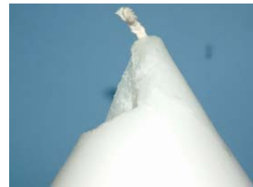
Bild 29: Sprödebruch durch Fräsen bei zu niedriger Temperatur
