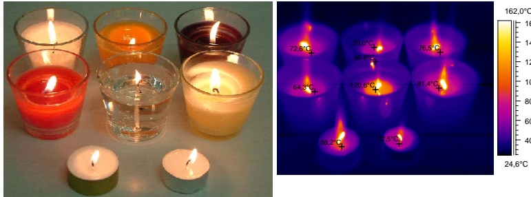
Bild 14: Brenntellertemperaturen unterschiedlicher Kerzenrohstoffe
