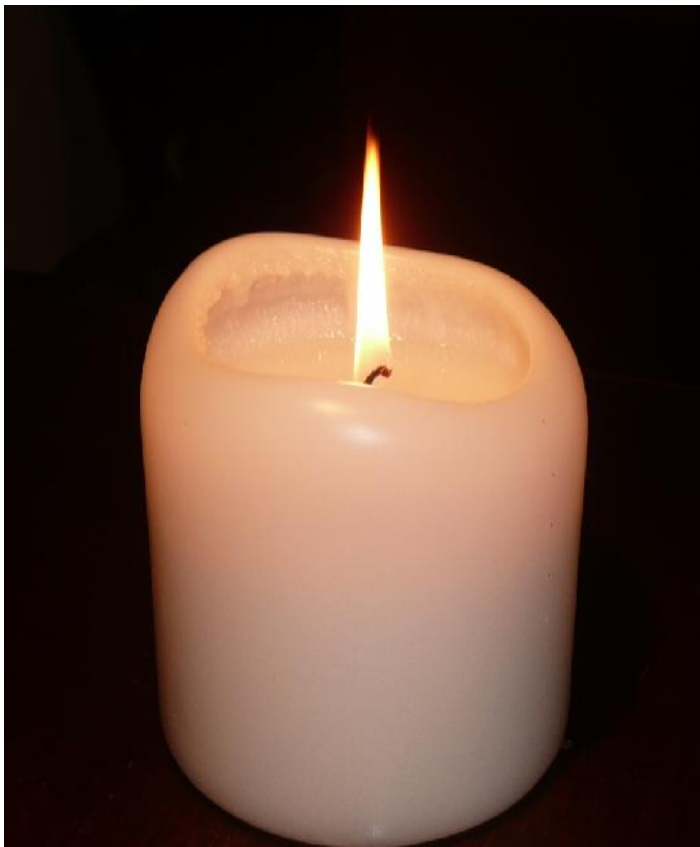
Abb. 2: Paraffinkerze mit einem Durchmesser von 100 mm nach einer Brennzeit von 20 Stunden
