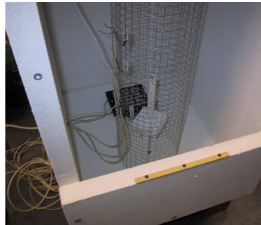
Abbildung 2: Zuluftöffnung auf der Oberseite der Prüfammer (links), Unterseite der Prüfammer (links) mit der Abluftöffnung und eingebaute Gitter zur Brechung der Luftströmung
