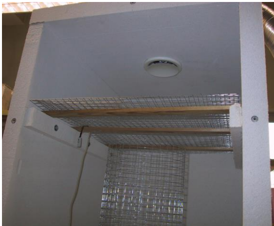
Abbildung 2: Zuluftöffnung auf der Oberseite der Prüfammer (links), Unterseite der Prüfammer (links) mit der Abluftöffnung und eingebaute Gitter zur Brechung der Luftströmung
