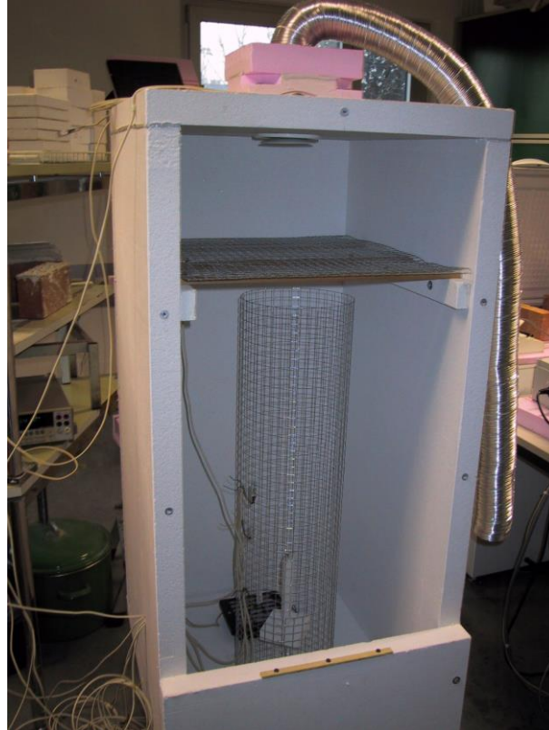
Abbildung 1: Prüfammer während des Aufbaus; Zuluftöffnung auf der Oberseite und Abluftöffnung auf der Unterseite
