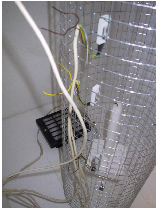
Abbildung 3: Im Bereich der Kerze befinden sich drei kombinierte Temperatur- / Luftfeuchtefühler
