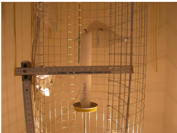
Abbildung 8: Bereich der Kerze in der Prüfkammer, Messfühler sind mit einer Aluminiumfolie abgeschirmt
