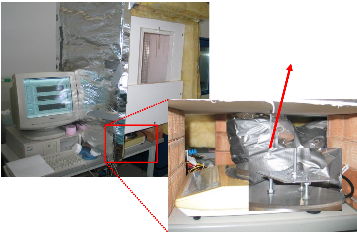
Abbildung 4: Dreifuß auf der Waage, dessen Verlängerung sich in der Klimakammer mit der jeweiligen Kerze befindet
