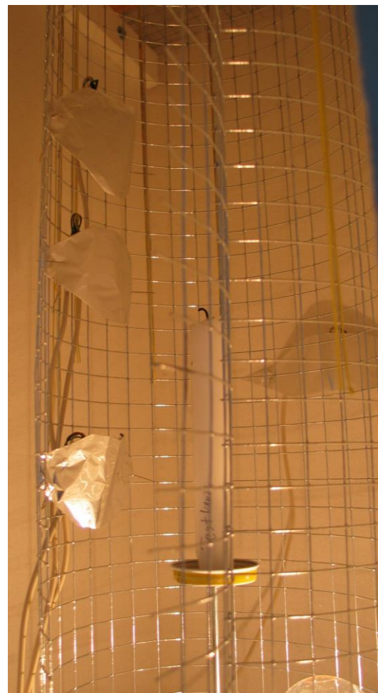
Abbildung 8: Bereich der Kerze in der Prüfkammer, Messfühler sind mit einer Aluminiumfolie abgeschirmt
