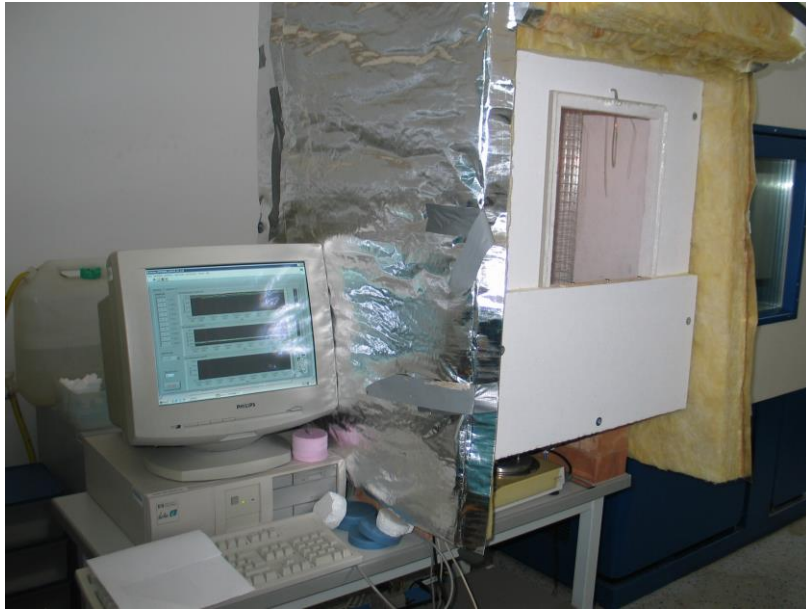
Abbildung 5: Fertiger Versuchsaufbau; v.l.n.r.: PC zur Messdatenerfassung (Temperatur, Luftfeuchtigkeit und Gewicht), Prüfchamber mit darunter befindlicher Waage, Klimaschrank zur Klimaregulierung
