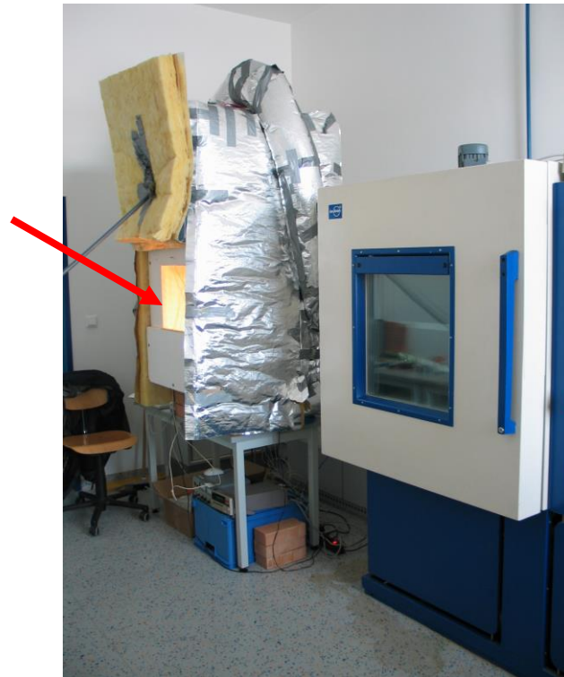
Abbildung 7: Bedienung der Prüfkammer (Wechsel der Kerzen, Ausrichtung etc.) erfolgt über eine frontseitige Öffnung
