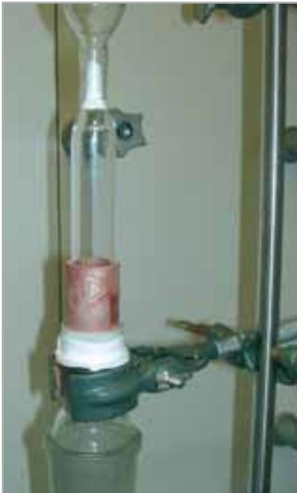
Abb. 2 Sammelkartusche für Glasfaserfilter
