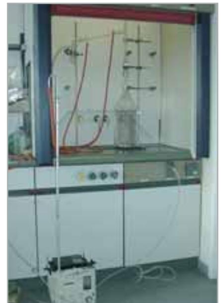
Abb. 1 Apparatur zur Rußbestimmung.
