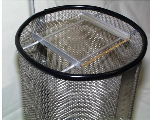
**Abbildung 1: Brennkorb am Stativ und aufgelegte Glasplatte im Detail**
