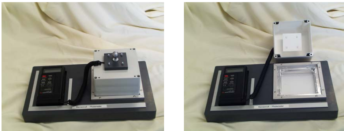
Abbildung 8: Photometerkonstruktion: Die berußte Glasscheibe wird unter den rechts sichtbaren integrierenden Kasten auf das Lichtpult gelegt. In der Oberseite des Kastens befindet sich der Detektor. Er ist über das Kabel mit dem digital anzeigenden Photometer (links) verbunden.
