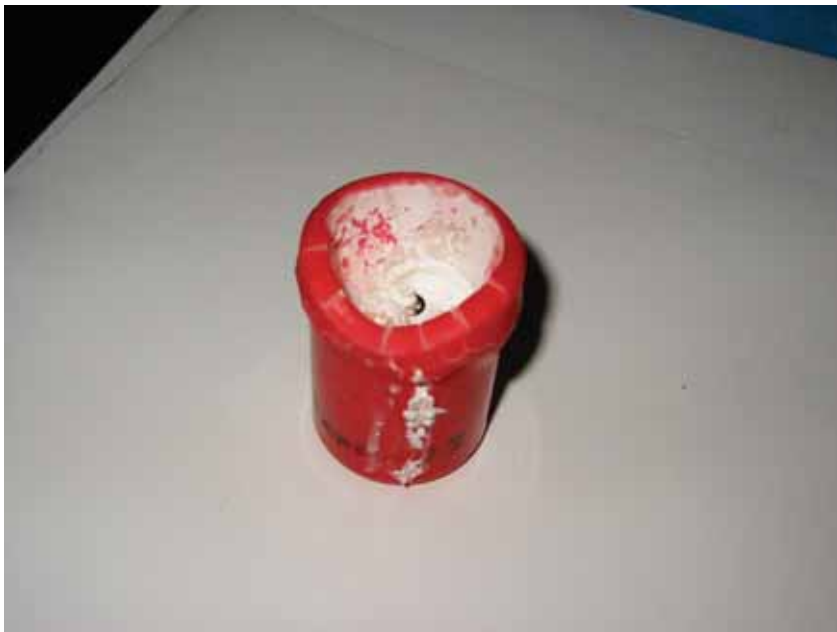
Abb. 5: Kerzenmuster nach weiteren Optimierungsschritten an den Mischungsverhältnissen – führte sukzessive zu besserem Abbrandverhalten
