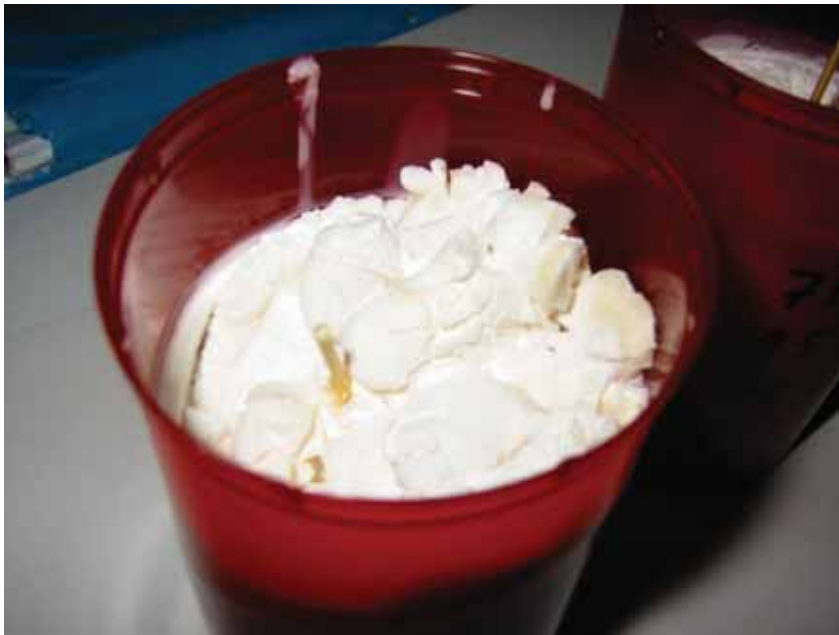
Abb. 1: Testmischungen am Beginn der Arbeiten, bei denen der sog. Popcorneffekt nach dem Abkühlen der Mischung eingetreten ist
