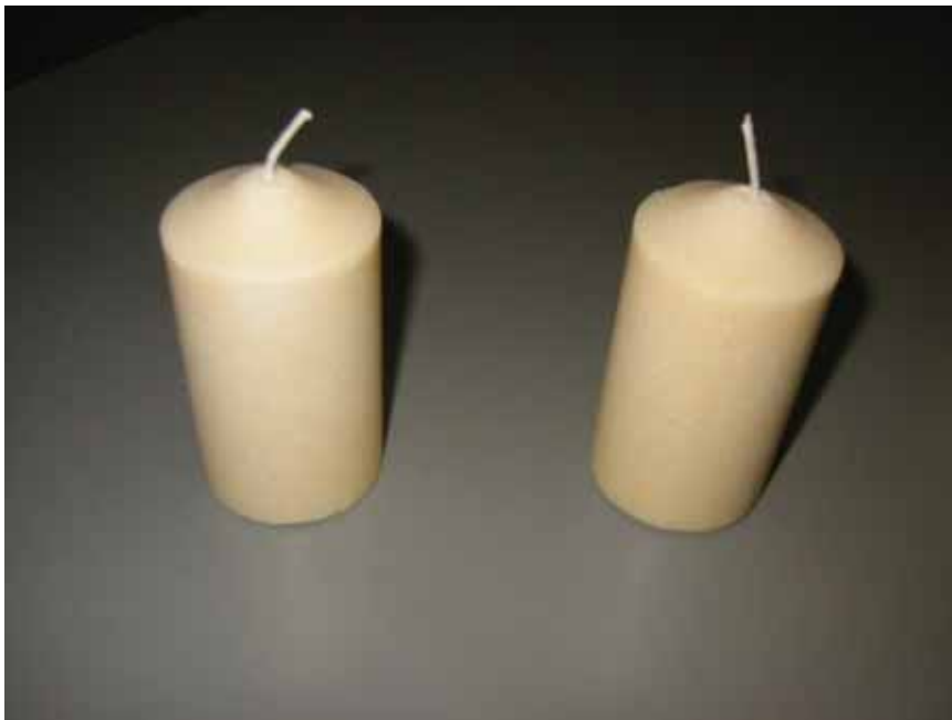
Abb. 7: Endprodukt des Projektes für Stumpenkerzen – guter Kerzenkörper, weitere Oberflächenoptimierungen erforderlich, auch Abbrandverhalten noch zu verbessern
