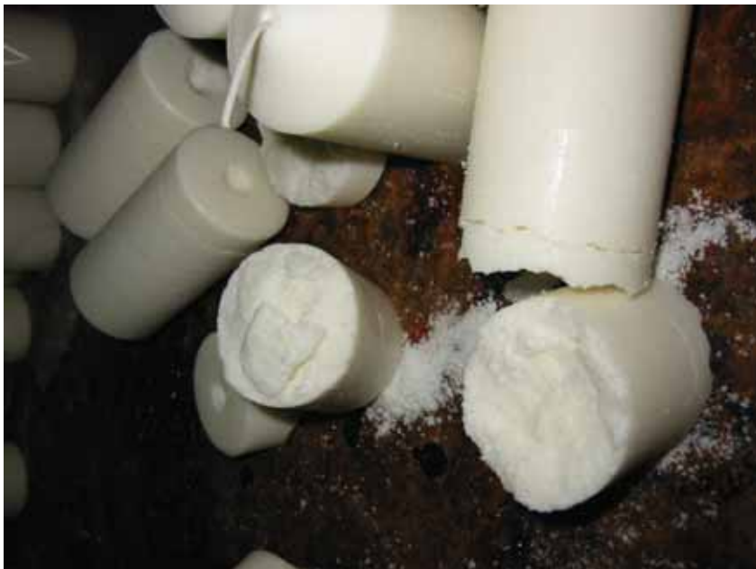
Abb. 2: Beispiel für Kerzen, die keine ausreichende „Kittsubstanz“ in der Rohstoffmischung beinhalten und daher keinen kompakten Kerzenkörper ergeben
