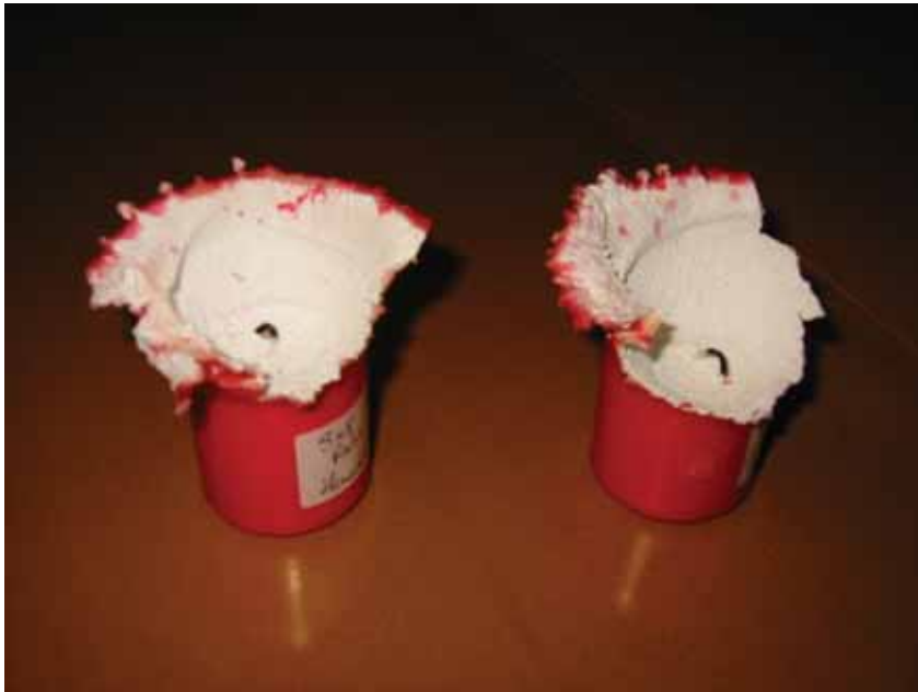
Abb. 4: Kerzenmuster nach Optimierungsstand von Abb. 3, jedoch noch mit unbrauchbarem Abbrandverhalten (bedingt durch den „Popcorneffekt“)
