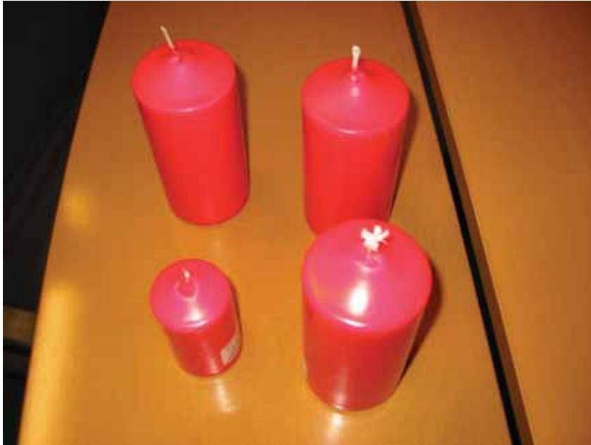
Abb. 3: Kerzenmuster nach ersten Optimierungsschritten beim Pressvorgang
