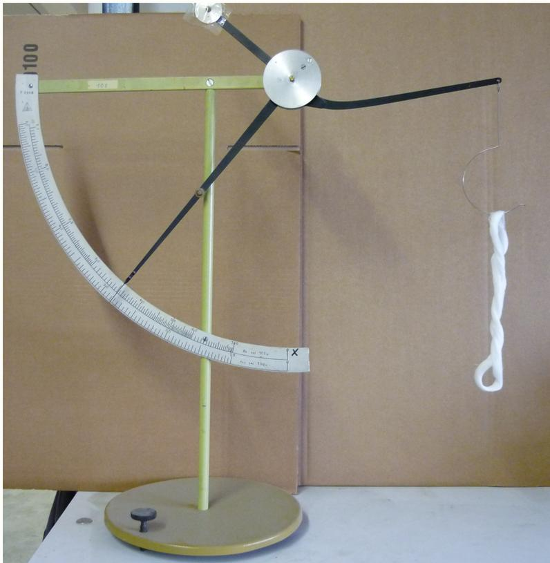
Balkenwaage mit Skala
